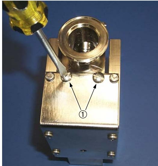
Figura 4-7 Viti con testa ad intaglio del complesso magnete
