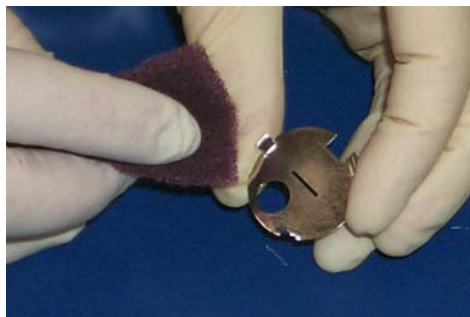
Figura 4-20 Piastra fessurata scolorita
